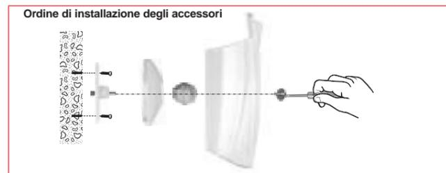
Per ragioni di sicurezza e di consumo della pila del rivelatore, è tassativamente necessario montare correttamente il perno d'autoprotezione. Nel caso in cui il perno non venga montato o venga montato in maniera errata, la spia luminosa rossa del rivelatore lampeggia in continuazione quando il rivelatore è agganciato sulla base.
