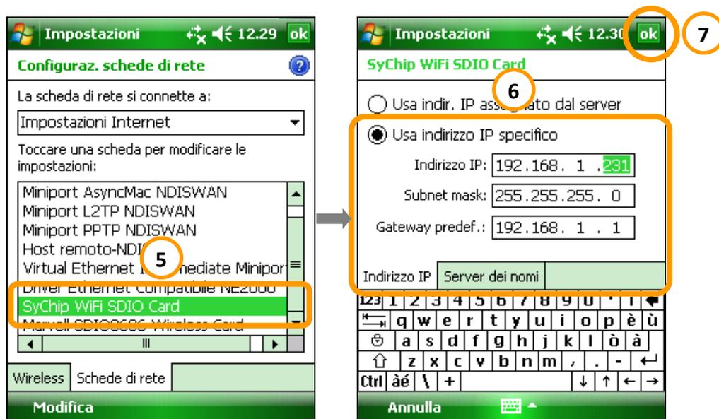
Scrivere nei campi appositi i valori scelti per l'INDIRIZZO IP, la SUBNET MASK ed il GATEWAY, che dovrebbero essere simili a quanto indicato in figura (passo 6). Confermare le modifiche premendo “OK” (passo 7) {vedere il manuale del dispositivo EzyDriveCAM – note al paragrafo 3 – per ulteriori dettagli}.
