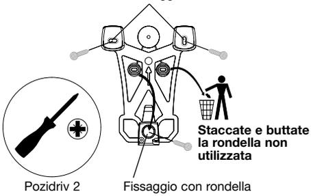
4. Agganciate la base del supporto di fissaggio.
