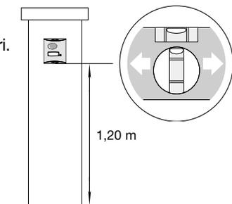
2. Identificate, segnate e forate i punti di fissaggio della placca esterna con una punta da  $\varnothing 6$  mm. Segnate anche la posizione del foro di passaggio del cavo da forare (minimo  $\varnothing 8$  mm consigliato).
