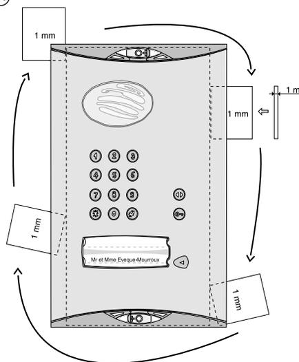
**ATTENZIONE:** dopo che la copertura in alluminio è stata posizionata sulla placca esterna, deve esserci 1 mm di distanza (per esempio utilizzate un calibro) tra il pilastro e la copertura.
