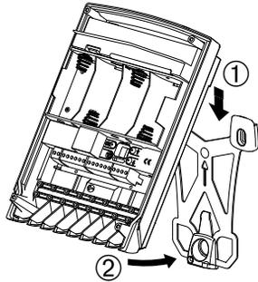
5. Bloccate la base tramite la vite di bloccaggio.
