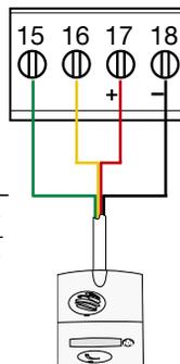
**SUGGERIMENTO:** se è necessario prolungare il cavo che collega la placca esterna al quadro elettronico, tagliate se necessario il cavo fornito alla lunghezza che vi è più utile e poi effettuate i collegamenti in una scatola di derivazione, osservando le seguenti indicazioni:
