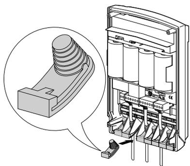
4. Bloccate i cavi collegati tramite i pressacavi e le viti fornite.
