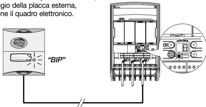
3. Per mantenere stagno il quadro elettronico, posizionate e bloccate tassativamente tutti i passacavi nei loro alloggiamenti facendo attenzione al senso di montaggio.
