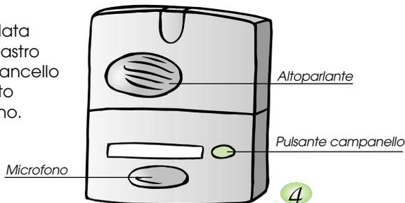
Installato sul pilastro del cancello dal lato interno. Contiene le pile per l'alimentazione della postazione esterna (quadro elettronico e placca esterna).
